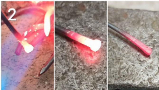
Schritt 3 - Erhitzt die Mitte des großen Nagels auf einer Breite von gut zwei Zentimetern und biegt ihn möglichst gleichmäßig zu einem Halbkreis.
