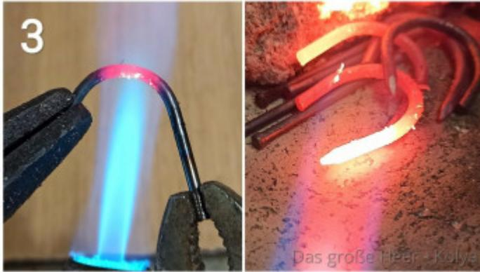
Schritt 4 - Erhitzt nacheinander die beiden Enden des großen Nagels und biegt sie im 90°-Winkel aufeinander zu, so dass sie sich in der Mitte berühren oder besser noch etwas überlappen. Hämmt die überlappenden Enden ein wenig flach, so dass sie zusammen möglichst nicht dicker sind als der eigentliche Nagel. Damit habt Ihr die eigentliche Schnalle schon fertig.
