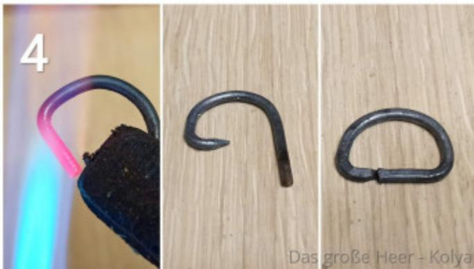
Schritt 5 - Erhitzt das flache Ende des kleinen Nagels und biegt es mit der Rundzange zu einem Halbkreis. Das wird die Öse des Dorns. Diese sollte so groß sein, dass sie bequem und mit ausreichend Spiel über die zusammen gehämmerten Enden des großen Nagels passt. Legt die Öse des Dorns wie auf dem Bild um die Mitte der Schnalle. Biegt sie nun mit der Spitzzange vollständig zusammen. Der Dorn muss sich noch frei um die Schnalle drehen lassen.
