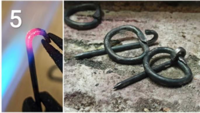
Schritt 6 - Kürzt den Dorn und feilt ihn vorne ein wenig schmaler zu, damit er später bequem durch die Löcher des Gürtels passt.
